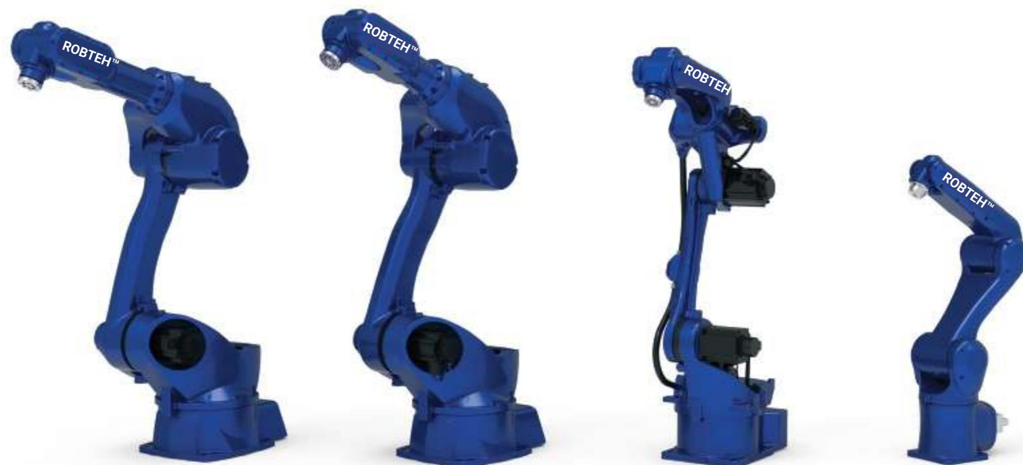
Модельный ряд универсальных шестиосевых манипуляторов ROBTEH™ серии AR-H обеспечивает высокую производительность для широкого спектра применений, например, для обслуживания станков, погрузочно-разгрузочных работ, удаления материала, сборки, аддитивного производства, дозирования, окрашивания, нанесения герметиков и многое другое.
